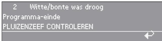
De displaymelding "Pluizenzeef controleren" verschijnt, als de pluizenzeef moet worden gereinigd.
