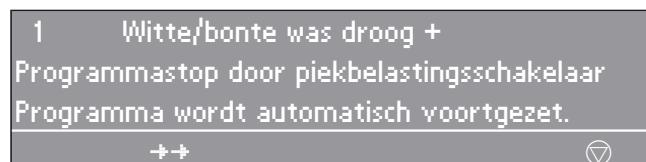
Als de piekbelasting voorbij is, wordt het programma automatisch voortgezet.
